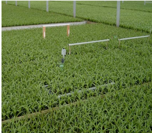
Afb. 2. Proefopstelling met standers voor behandelingen met minder watergiften. Op de voorgrond PARmeting en een geïnstalleerde weegunit.
