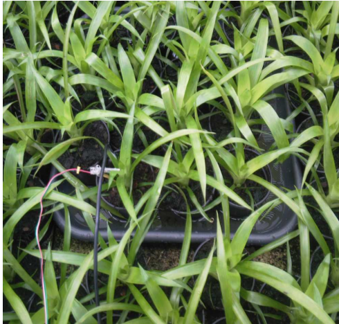
Afb. 1. De behandelingen met hoog vochtgehalte substraat werden gecreeerd door middel van containers met op 1 cm een draingat.
