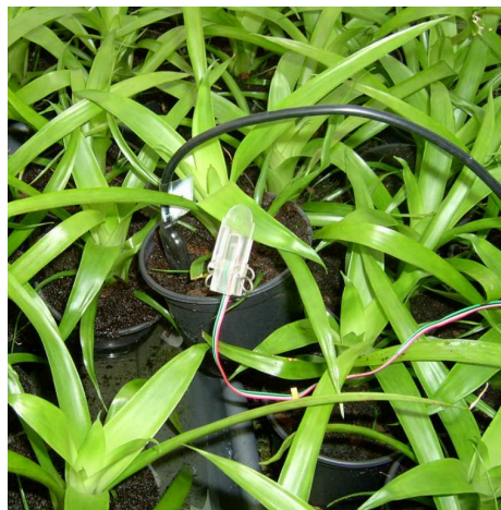
Afb. 3. Meting met weegunit (links) en pot met vocht- en bladdiktesensor (rechts).
