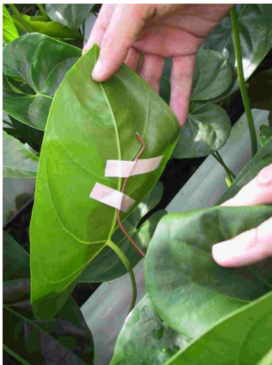
Foto 4. Bladtemperatuurmeting met thermokoppel bij Anthurium
